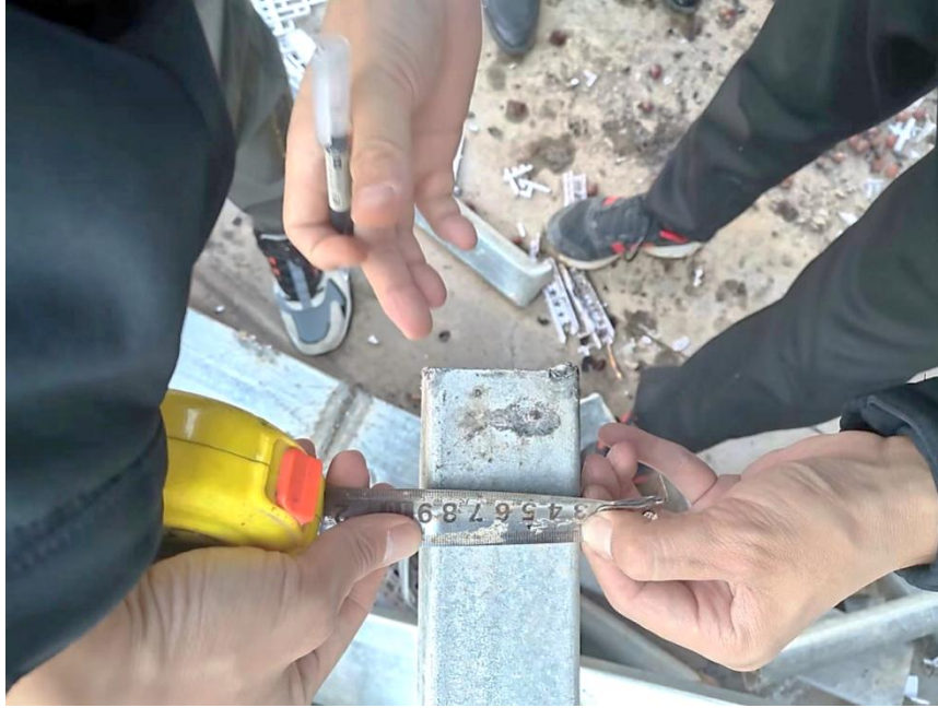
图9 主梁宽度现场实测图片
